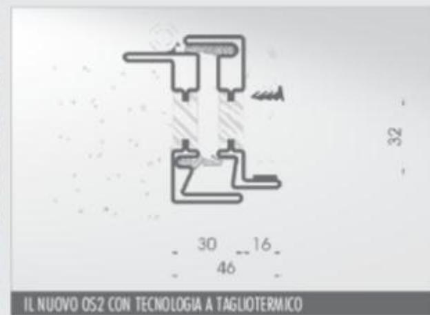
**Il telaio in acciaio corten a taglio termico, è una soluzione in grado di coniugare il miglioramento energetico con un discreto inserimento nell'organismo storico, grazie ad uno spessore in vista inferiore ai 5cm e di circa 6,5cm nella sovrapposizione dei battenti.**
